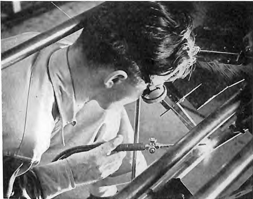
"DOWN-WELD" FOR EASE OF OPERATION
